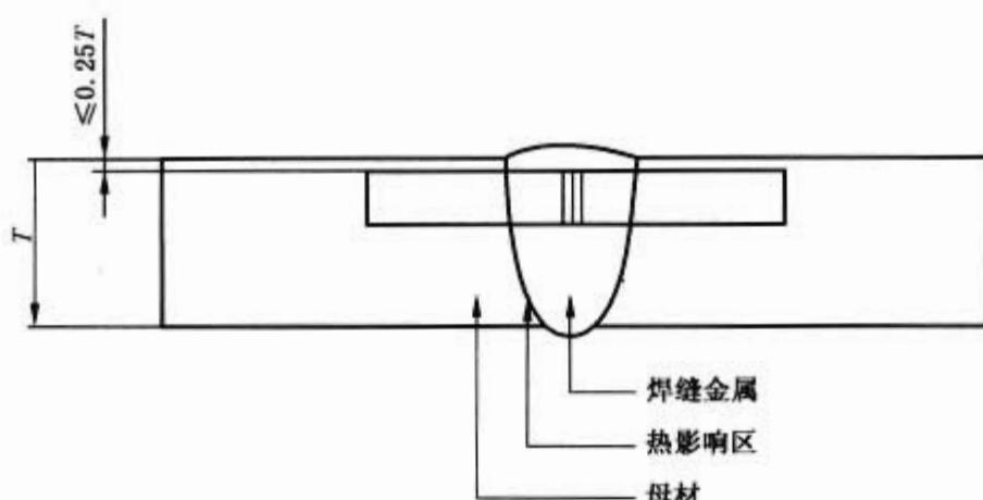
图 11 焊件金属件的试样位置
